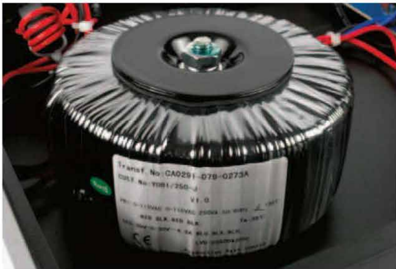
TOROIDALE Il trasformatore di alimentazione è toroidale. La sua potenza è di 250 watt, quindi dimensionato per un carico di 80hm. È dotato di un unico secondario da 2 x 30V.
